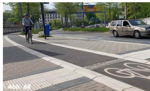
Abb. 68: Niveaugleicher Radweg vor einer Haltestelle. Der Auffindestreifen führt bis zum Trennstreifen. Auf dem Radweg unterstützt hier ein Pflasterstreifen die Orientierung. (Quelle: Railbeton Haas KG)
