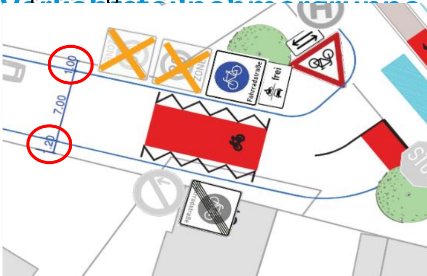
Unzureichende Einbindung des Fußverkehrs
