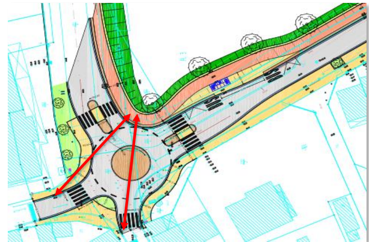
süd- und westlicher Knotenpunktarm nicht mit Radverkehrsanlage verknüpft
